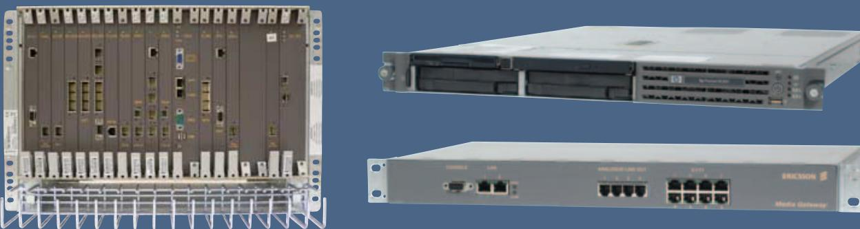
MX-ONE™ — полнофункциональная IP-АТС с возможностью масштабирования до 50 000 пользователей. В ее основе используются открытое программное обеспечение и оборудование, работающее в системе Linux и на стандартных серверах.
